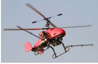
图 4 FH-1 共轴式无人直升机辨识实验数据采集
