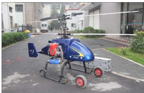
图 1 北京航空航天大学自主研制 FH-1 共轴式无人直升机
